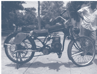
Rikimbili, vélo équipé d'un moteur de pompe à eau.
