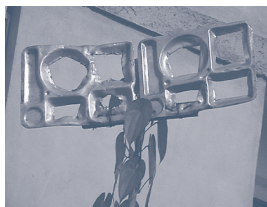
Antenne de télévision fabriquée à partir de plateaux de cantines d'écoles et de centres de travail.
